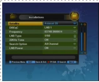
1. Спутник: Нажмите кнопку OK, для того чтобы открыть список спутников. Выберите необходимый спутник и нажмите кнопку OK.
