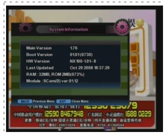
: Это окно выводит основную информацию о том, какую версию аппаратного и программного обеспечения использует ваш приемник.
