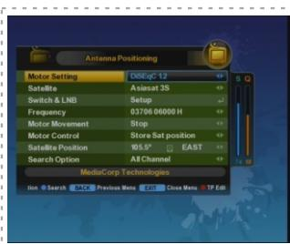
1. Motor settings (Настройка мотора): Нажмите кнопку OK, для того чтобы открыть список настроек Мотора. Выберите необходимые настройки мотора и нажмите кнопку OK.
