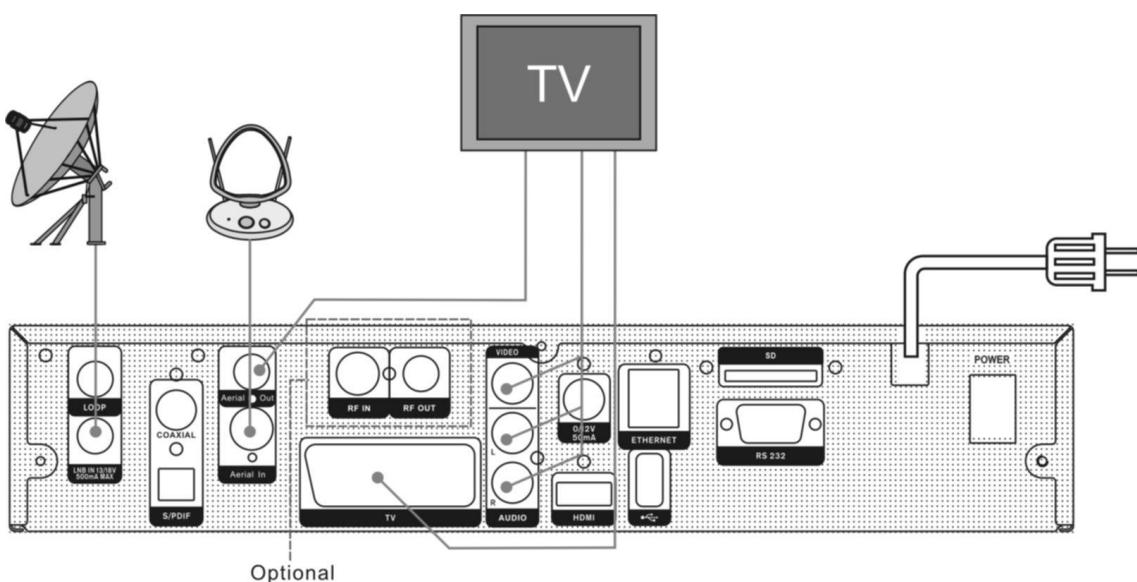
В заключении, соедините коаксиальным кабелем спутниковый приемник (гнездо LNB IN) и конвертер(LNB), установленный на спутниковой тарелке.
