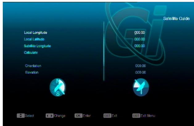
«Спутниковый гид» предназначен для расчета ориентации антенны на спутник, для этого необходимо ввести долготу и широту месторасположения своей антенны и долготу спутника.
