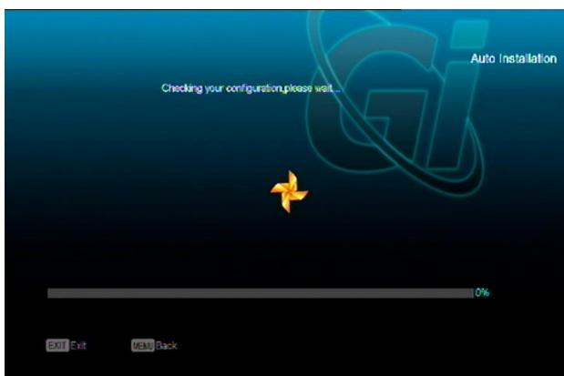
Данная функция позволяет автоматически определить конфигурацию всех антенн, подключенных к приемнику, после чего произведет поиск в соответствии с полученными параметрами.
