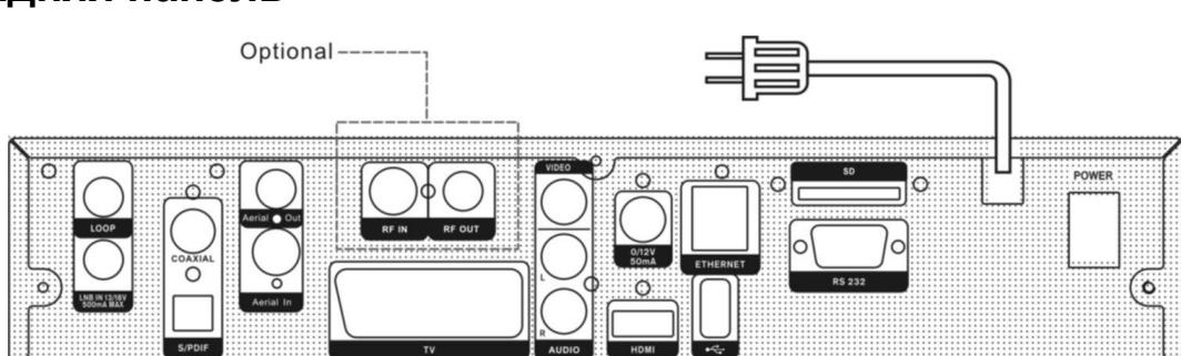
Пожалуйста, проверьте доступные типы подключения на приведенном выше изображении. Конфигурация вашего приемника может различаться в зависимости от модели.
