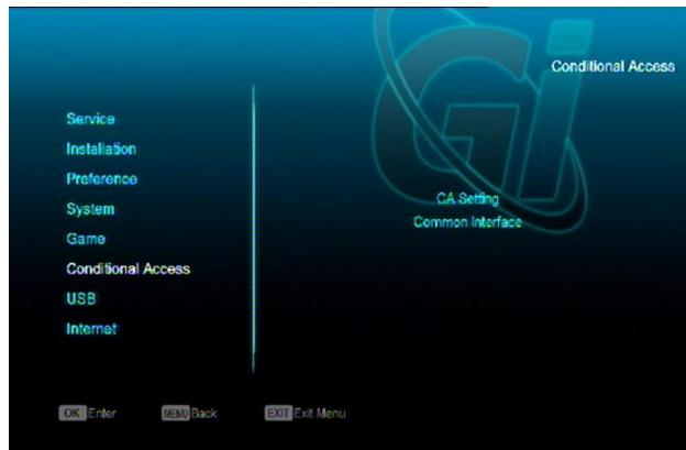
Приемник оснащен одним слотом для карты условного доступа. Модуль для карты имеет встроенный декодер. Используя карты, предоставленные оператором, у вас появляется возможность просматривать закодированные каналы. В этом меню представлена детальная информация о карте, вставленной в слот.
